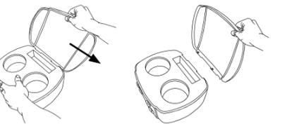
Tenir l'appareil fermement avec une main. Tirer sur le couvercle dans le sens de la flèche avec l'autre main.
